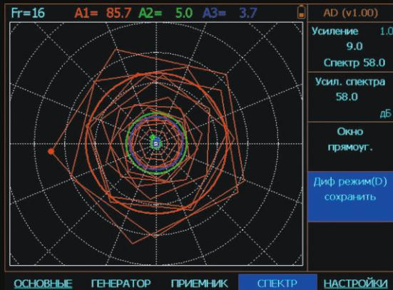
Непрерывный режим возбуждения с отображением сигнала в комплексной плоскости
