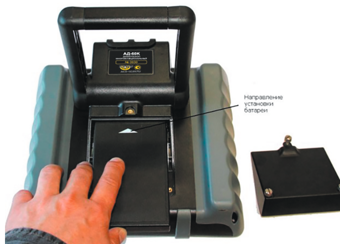
Рис 1-4 Установка нового аккумулятора
