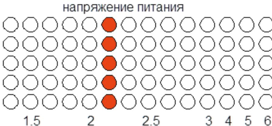
Положение маркера соответствует напряжению источника питания. Цифры под рисунком соответствуют напряжению в вольтах. Рекомендуется заряжать аккумулятор при снижении напряжения ниже 1.6 Вольт. При напряжении выше 6 Вольт прибор может выйти из строя. Функция отображения напряжения питания будет выполняться при каждом нажатии кнопки «ВОЗДУХ»
