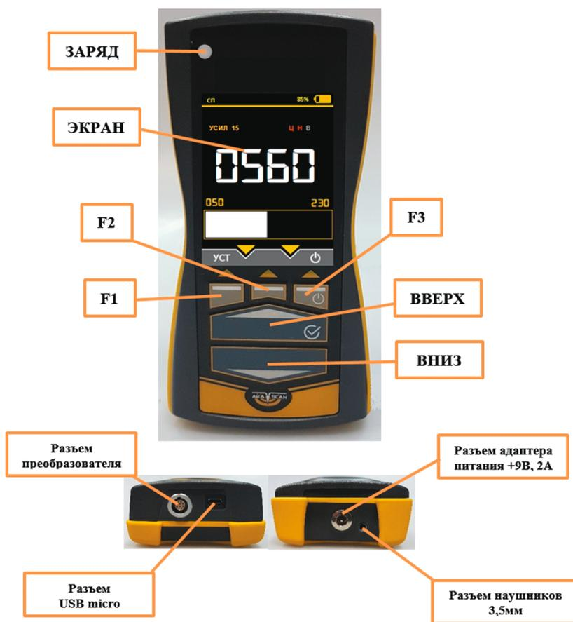
Рис.1 Внешний вид дефектоскопа ИД-92НМ (версия 2)
