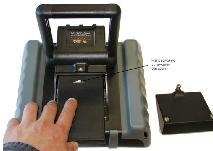
Рис 1-4 Установка нового аккумулятора
