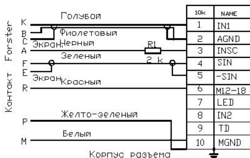
б) подключение ротационного датчика Forster
