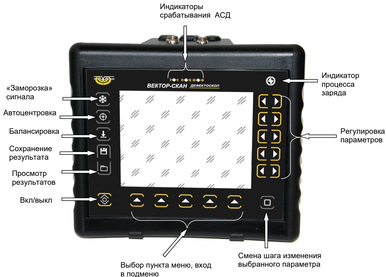
Рис 1-3—Клавиатура дефектоскопа
